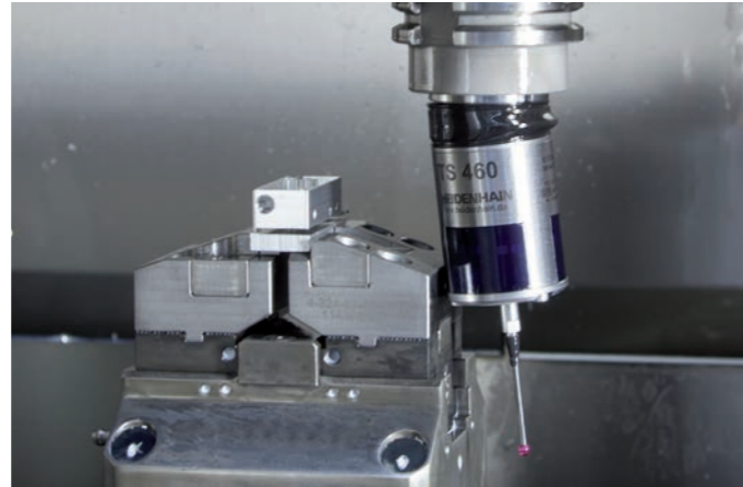
Kollisionsschutzadapter schützt Tastsystem und Spindel
